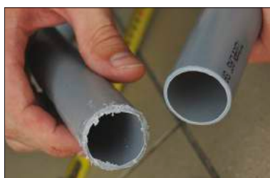
Рез ножовкой (слева) по сравнению с P-TEC 3240 (справа).
