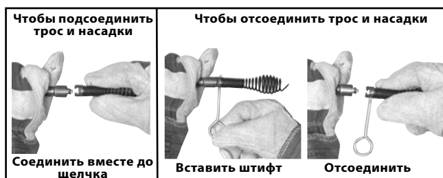
Рисунок 11 – Подсоединение и отсоединение насадок
