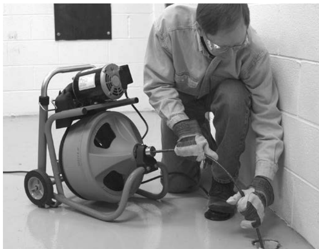
Рисунок 12 – В рабочем положении, подаваемая ручную спираль
