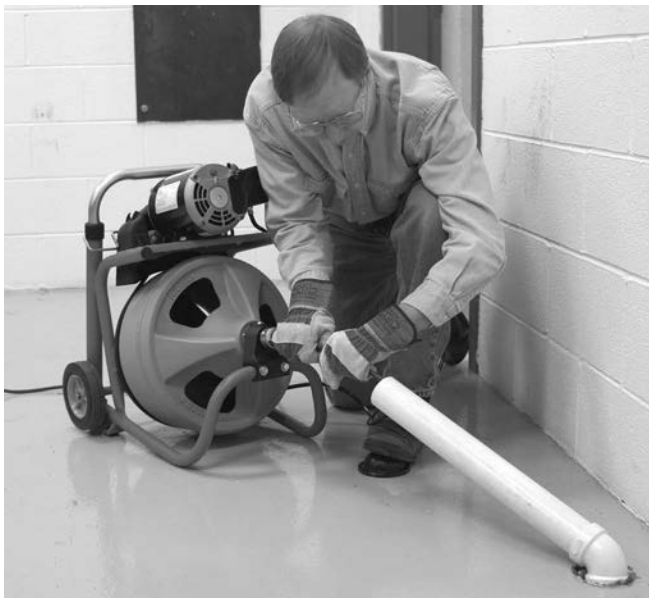
Kuva 9 – Esimerkki viemäriaukon pidentämisestä 2' päähän
