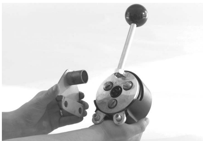
Figur 3 – Påsætning af monteringsbeslag på AUTOFEED
