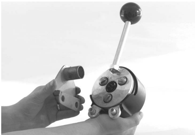
Figura 3 – Montarea etrierului de reazem în AUTOFEED
