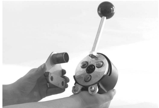
Kuva 3 – Kiinnityskannattimen asettaminen AUTOFEED-automaattisyöttöön
