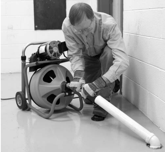
Figura 9 – Fórmula para alargar la entrada al desagüe hasta menos de dos pies de la nariz de la limpiadora
