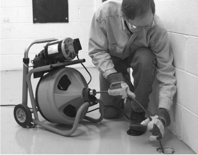
Şekil 12 – Çalışma Konumunda, Spiralin Manüel Olarak Beslenmesi
