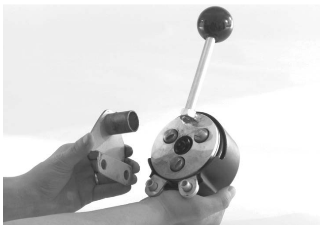
Obrázok 3 – Pripojenie montážnej konzoly k mechanizmu AUTOFEED
