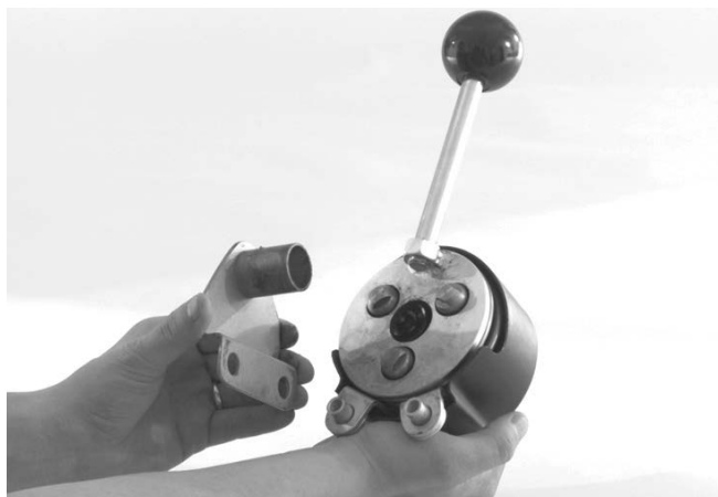
Obrázek 3 – Umístění montážní konzoly do AUTOFEED
