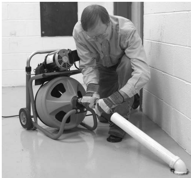
Obrázok 9 – Príklad predĺženia odtoku do vzdialenosti 2' od otvoru bubna
