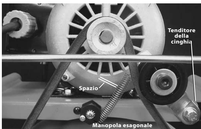
Figura 16 – Regolazione del limitatore di coppia. (Raffigurato con la protezione della cinghia rimossa)
