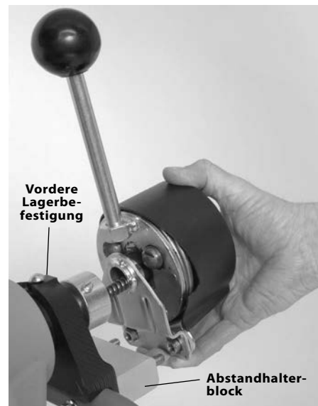
Abbildung 4 – Befestigen der AUTOFEED am Rahmen
