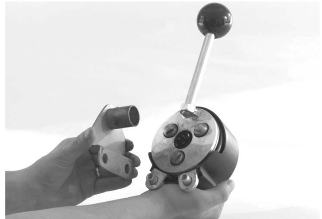
Abbildung 3 – Einsetzen der Befestigungshalterung in die AUTOFEED
