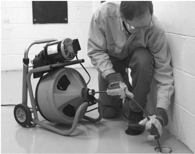
Figuur 12 – In bedieningspositie, handmatige veervoer
