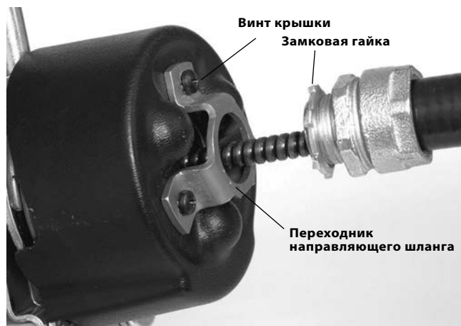
Рисунок 5 – Монтаж направляющего шланга на AUTOFEED
