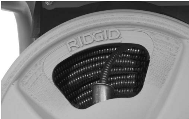
Figur 17 – Kveil kabelen i trommelen som vist
