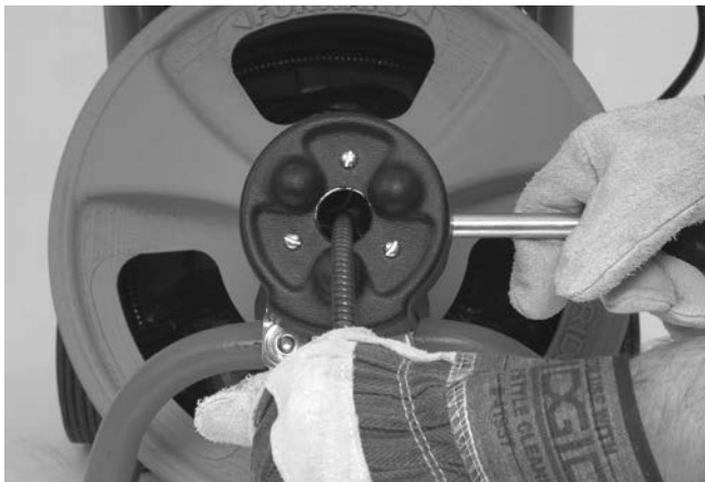
Figur 14 – AUTOFEED i uttrekkingsposisjon
