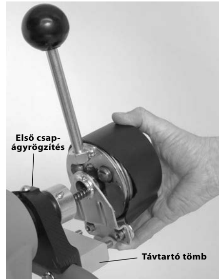
4. ábra – Az AUTOFEED felszerelése a keretre
