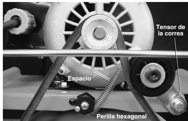
Figura 16 – Ajuste del limitador del par de torsión (se ha quitado la cubierta de la correa)
