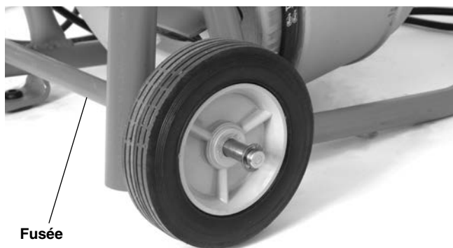
Figure 2 – Montage des roues
