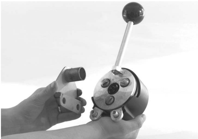
3. ábra – Szerelőkonzol elhelyezése az AUTOFEED-BEN
