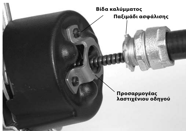
Εικόνα 5 – Τοποθέτηση λαστιχένιου οδηγού στο AUTOFEED (Μηχανισμός αυτοπροώθησης)
