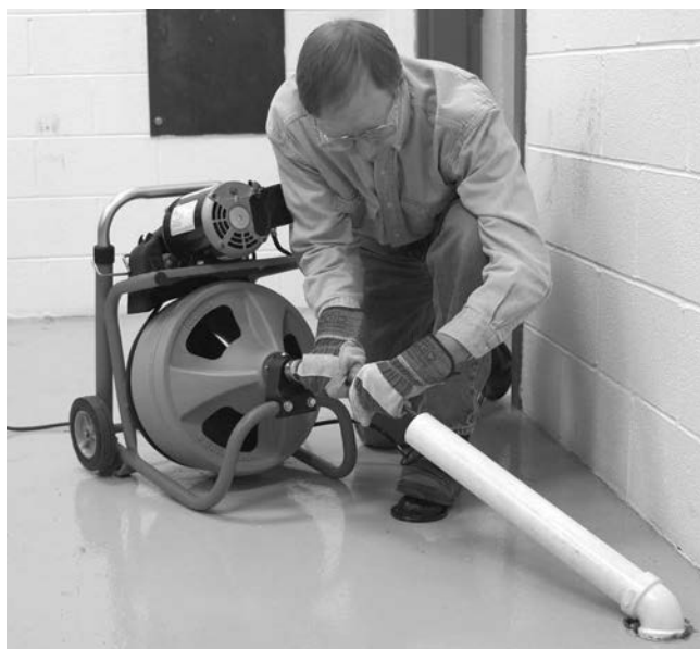
Figura 9 – Esempio di prolungamento dello scarico fino a un massimo di 2 piedi dall'apertura dello scarico
