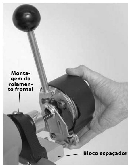
Figura 4 – Montagem AUTOFEED (Avanço automático) na estrutura
