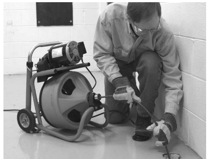
Εικόνα 12 – Στη θέση λειτουργίας, χειροκίνητη προώθηση του καλωδίου
