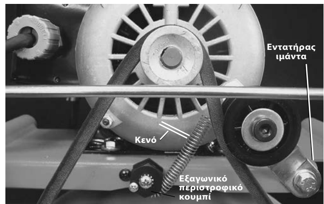
Εικόνα 16 – Ρύθμιση περιοριστή ροπής. (Εικονίζεται χωρίς το προστατευτικό του ιμάντα)
