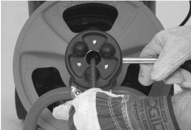
Figura 14 – AUTOFEED in posizione di recupero
