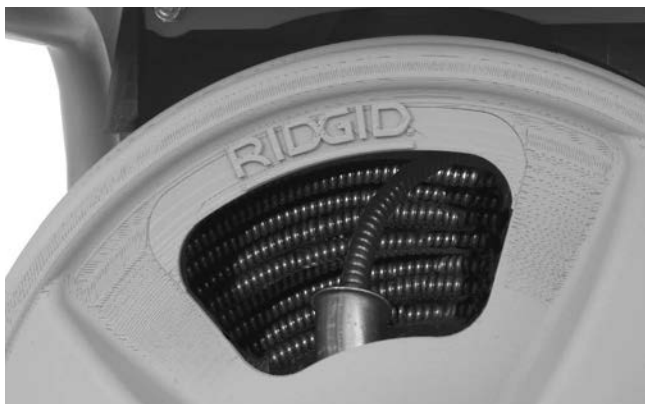
Slika 17 – Kabel tuljave v boben, kot je prikazano
