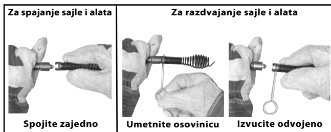
Slika 11 – Spajanje i razdvajanje alata
