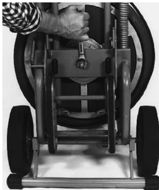
Figura 19 – Extracción del perno en el soporte trasero
