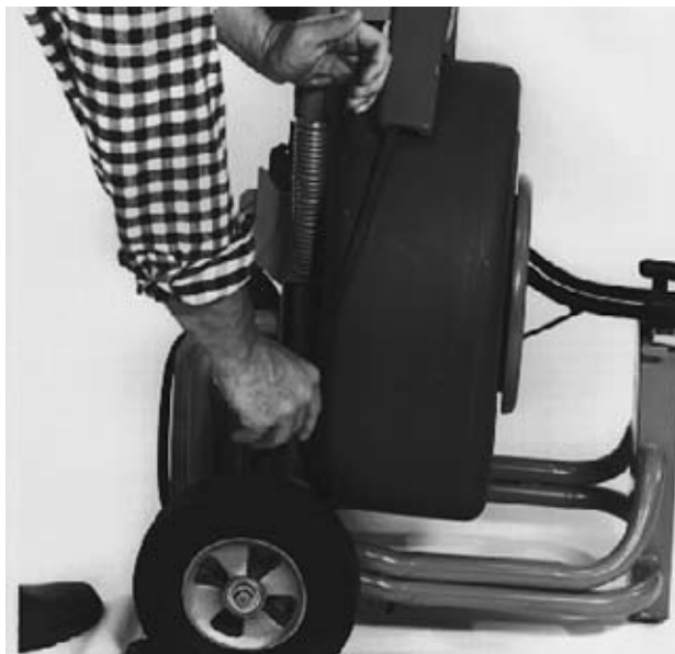
Figura 18 – Afloje la tensión de la correa
