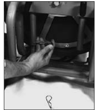
Figure 5 – Verrouillage des poignée à l'aide des goupilles. Serrage des deux (2) manettes et forme de T.
