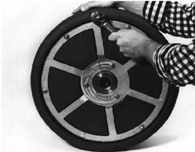
Figura 23 – Extracción del perno de sujeción de la colita de cerdo
