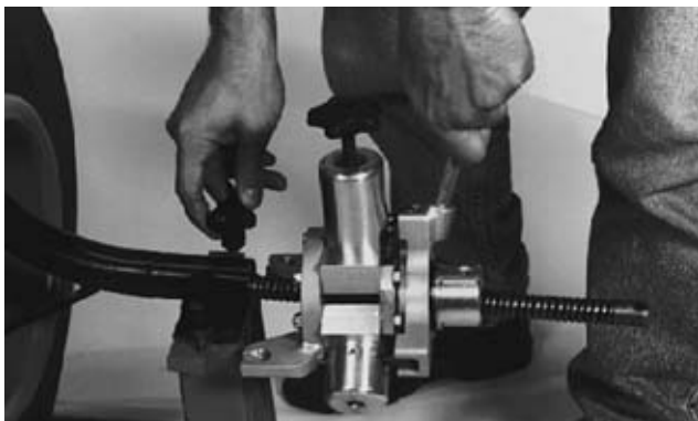
Figure 14 – Retrait du système d'entraînement AUTOFEED
