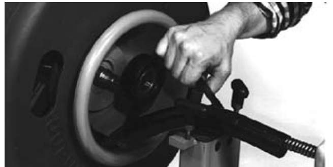
Figura 22 – Extracción del tubo guía
