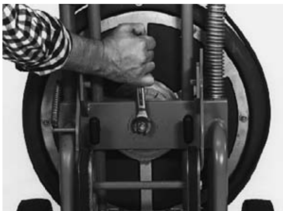
Figure 7 – Vérifiez le serrage du boulon
