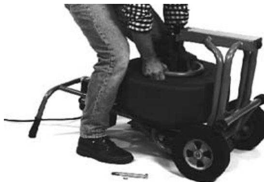
Figure 20 – Positionnement du tambour sur le cadre
