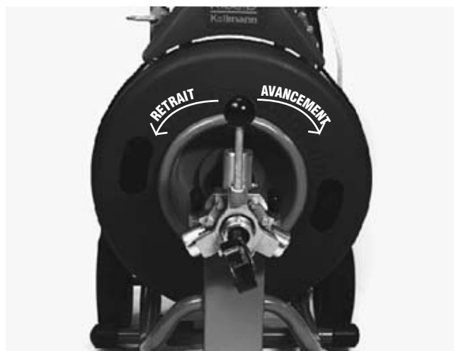
Figure 11 – Utilisation du levier d'entraînement
