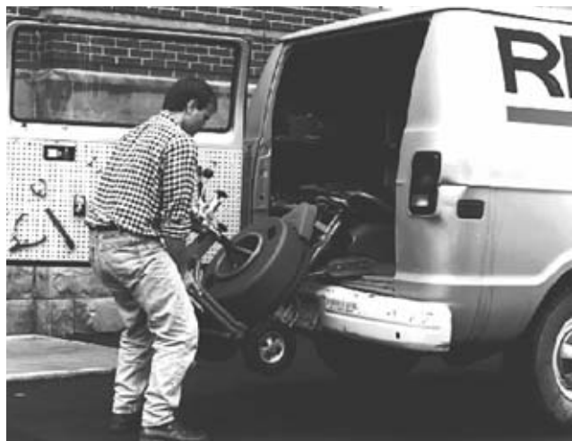
Figura 12 – Técnica para subir la máquina a una camioneta
