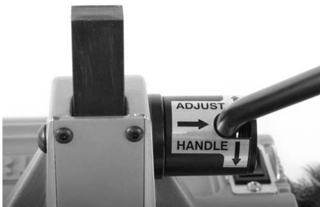
Figura 8 – Cómo ajustar la posición de la manivela
