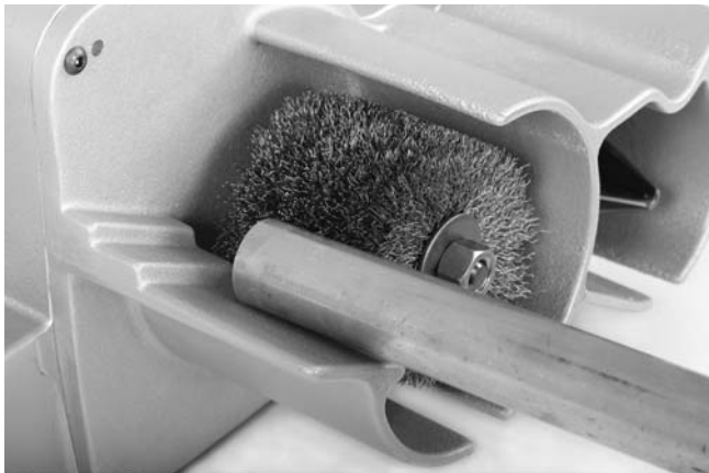
Figura 11 – Limpieza del exterior del tubo
