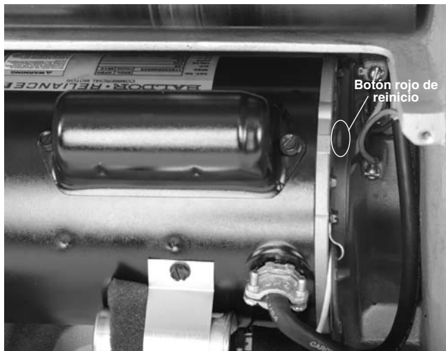
Figura 18 – Botón de reinicio del motor
