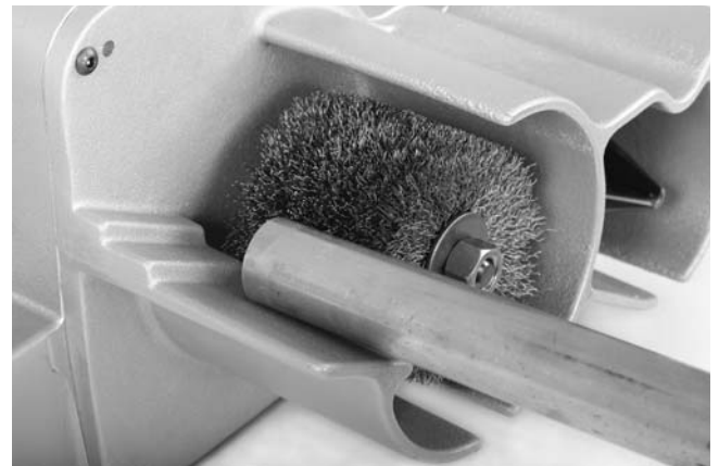
Figure 11 – Nettoyage externe du tube
