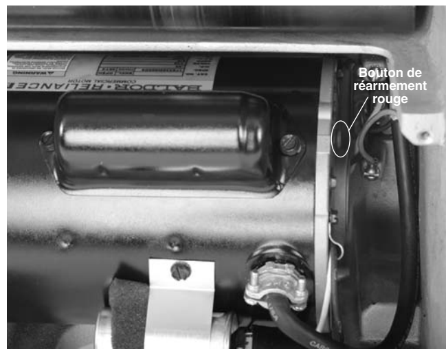
Figure 18 – Bouton de réarmement
