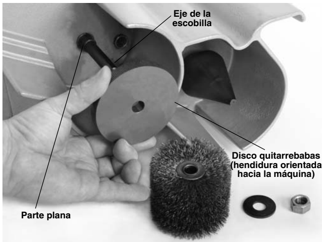
Figura 5 – Montaje del disco quitarrebabas
