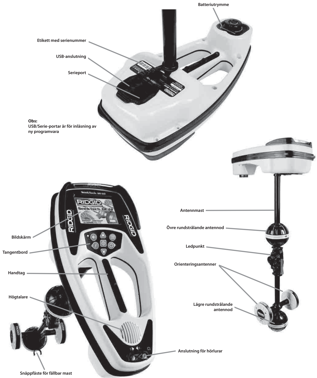
Figur 1: Komponenter i SR-60
