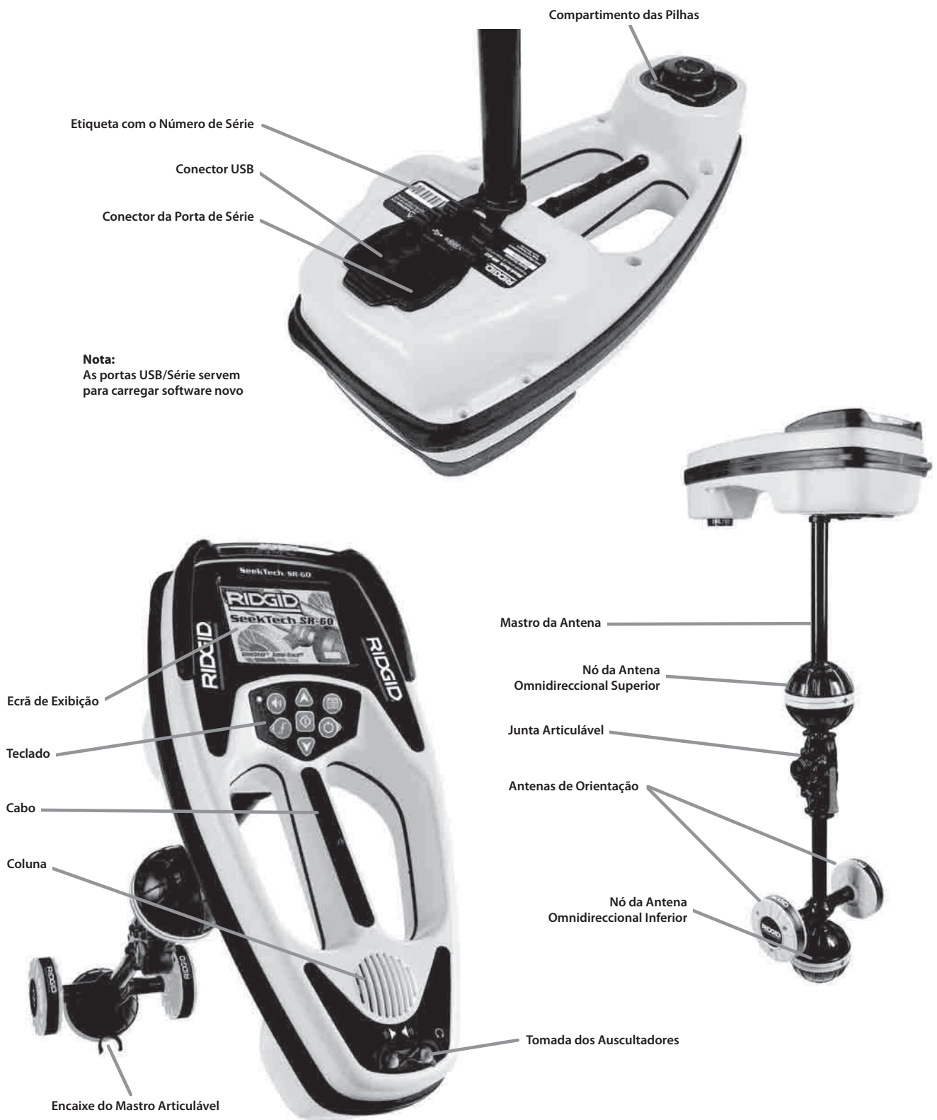
Figura 1: Componentes do SR-60
