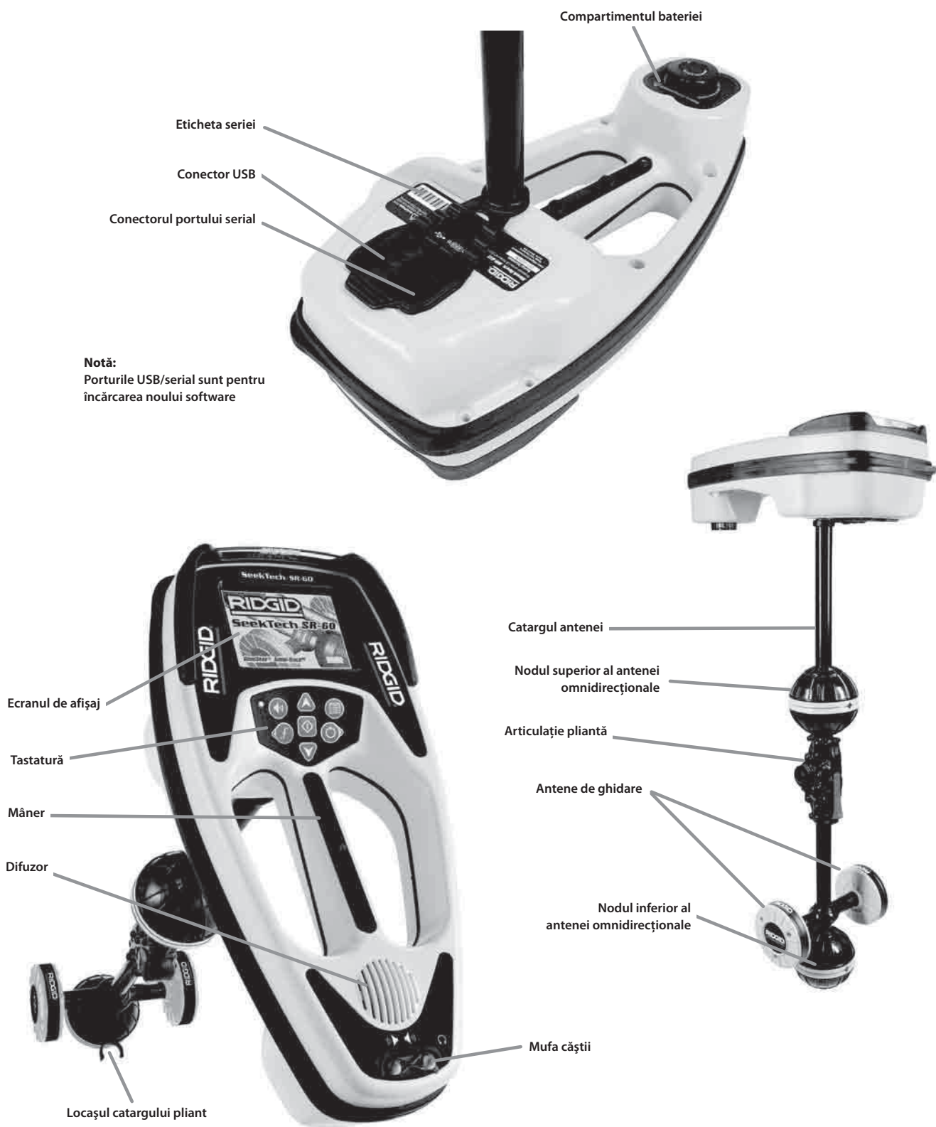
Figura 1: Componentele SR-60
