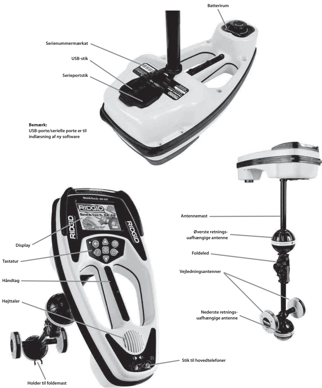
Figur 1: SR-60-komponenter
