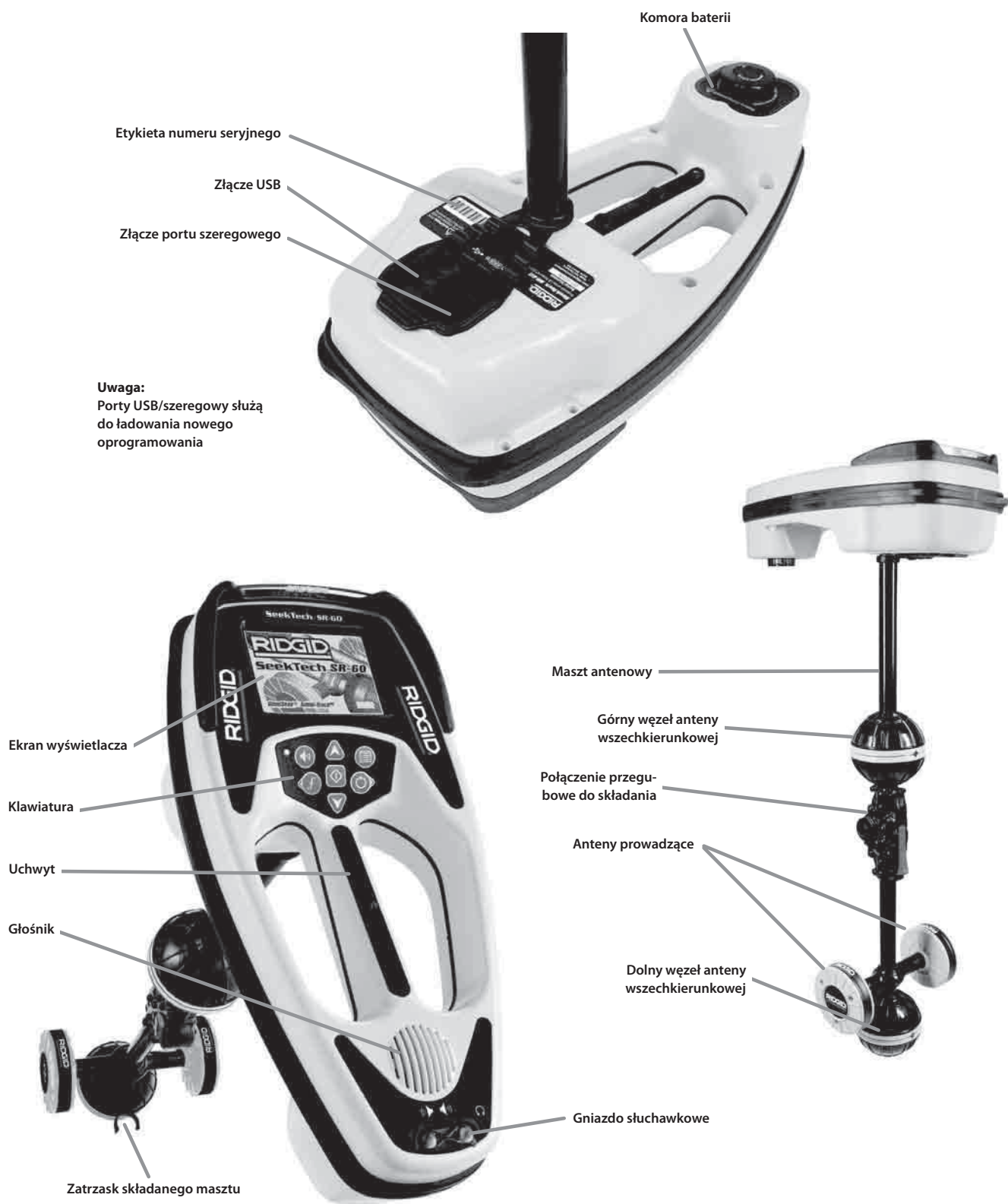
Rysunek 1: Części składowe SR-60
