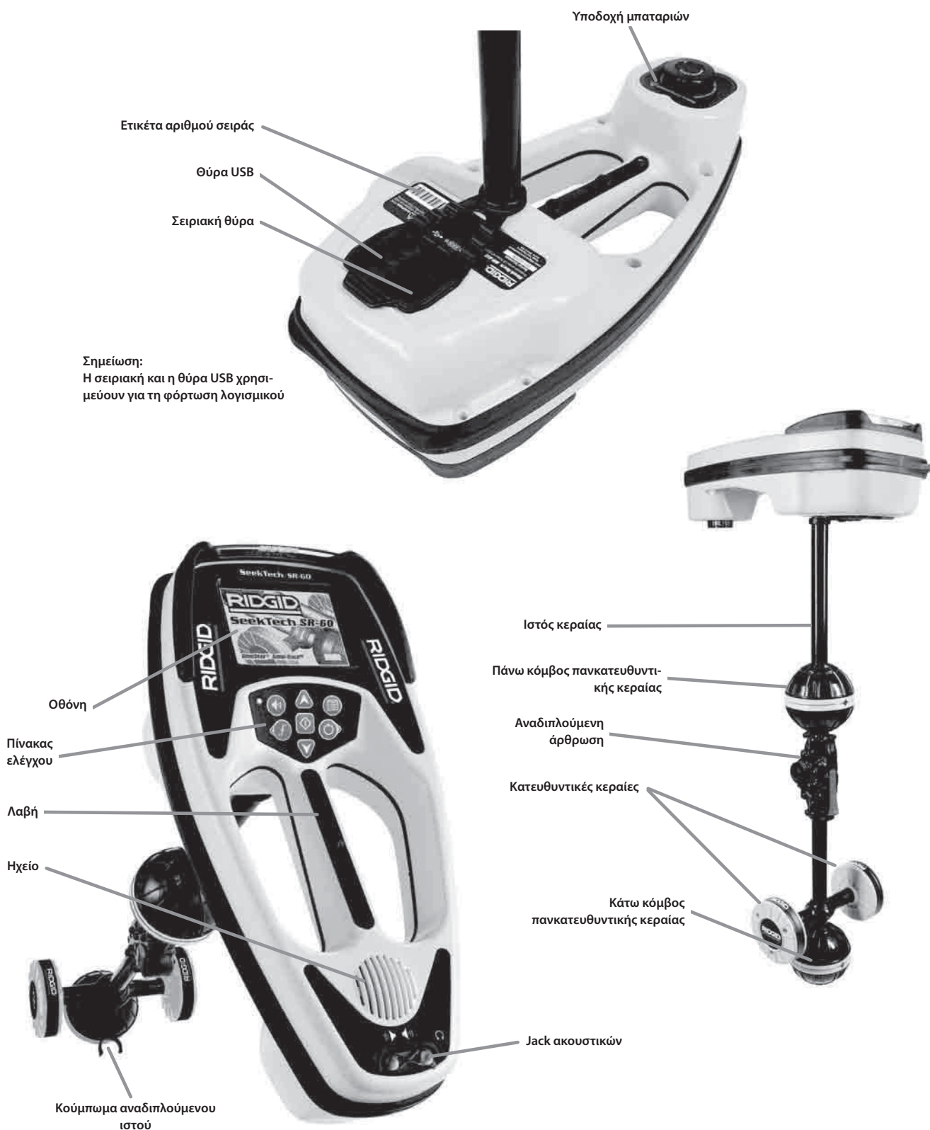
Εικόνα 1: Εξαρτήματα του SR-60
