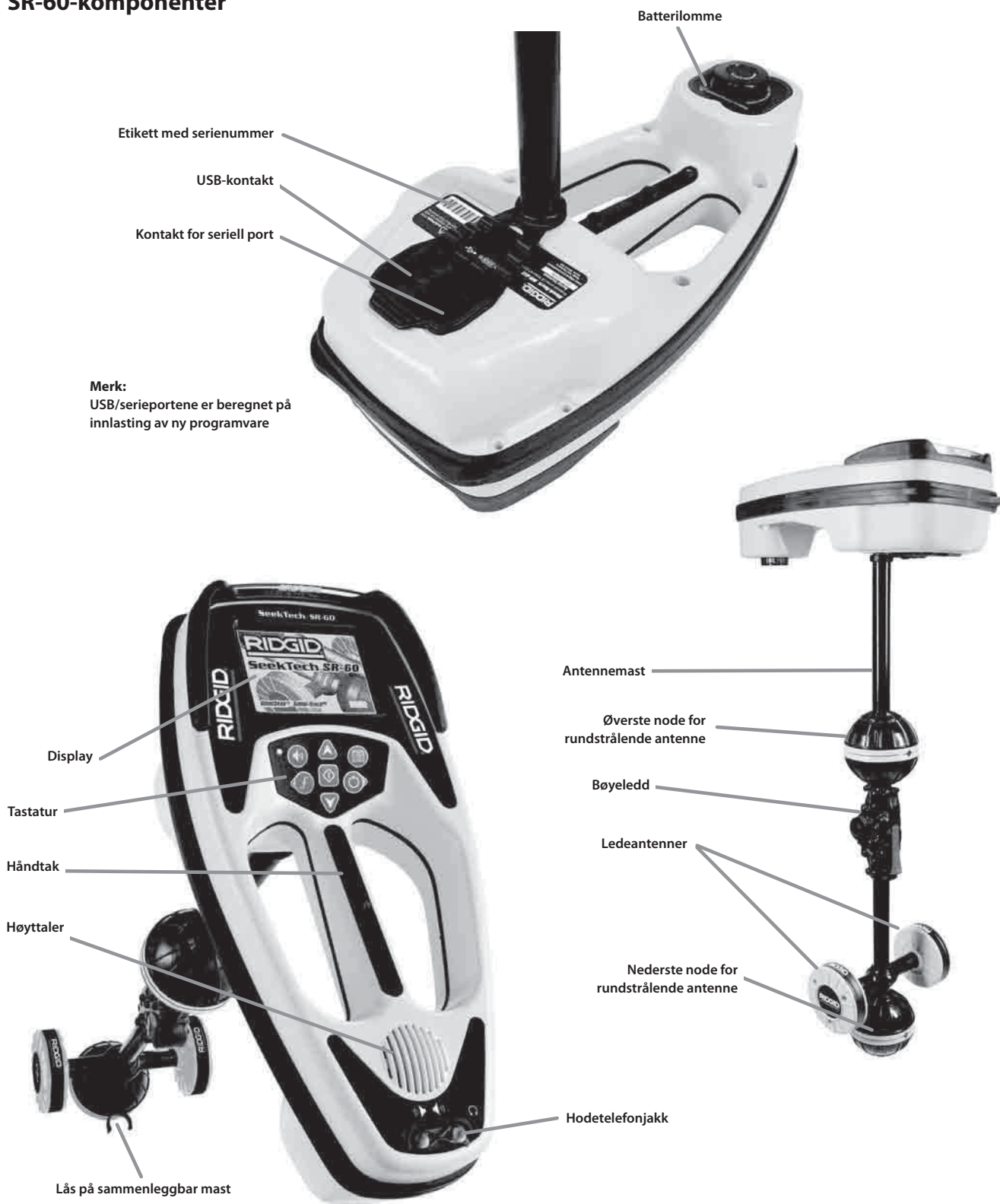
Figur 1: SR-60-komponenter
