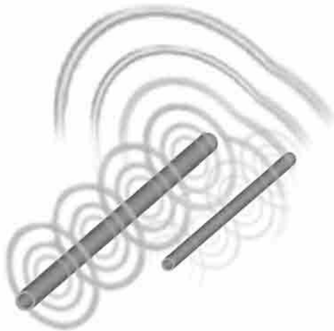
Εικόνα 68: Εκτροπή σήματος σε άλλο αγωγό
