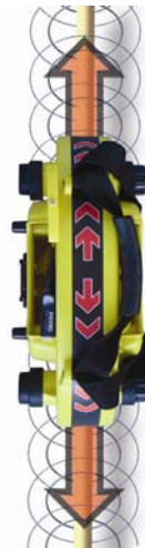
Рис. 8: Совмещение в индукционном режиме
