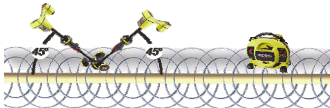
Рис. 12: Проверка наличия индуктивной связи через воздух
