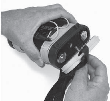
Figur 3: Ta av batteridekselet
