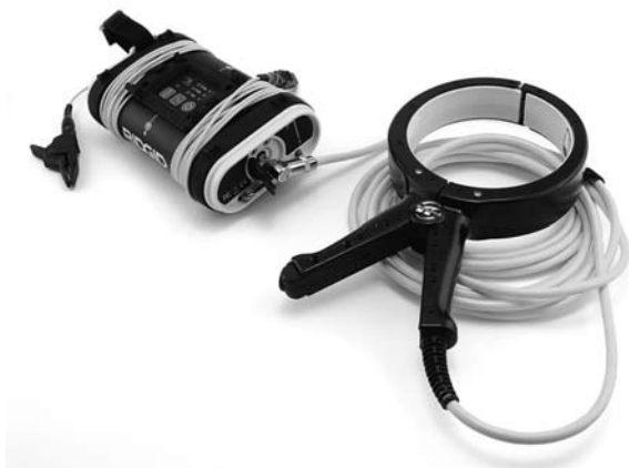
Рис. 8: Прибор ST-305 с индукционным зажимом
