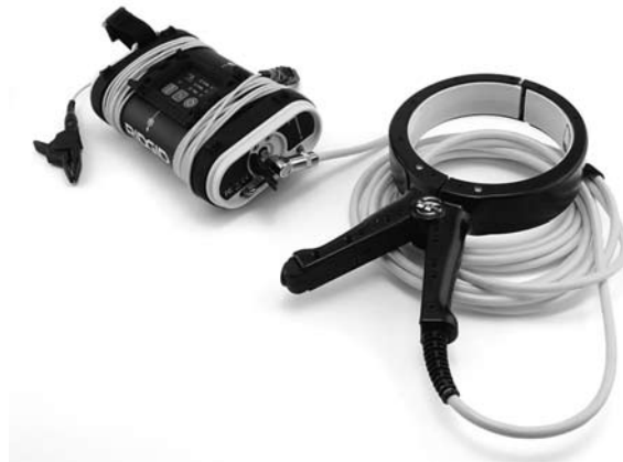
Figure 8: Le ST-305 avec pince inductive
