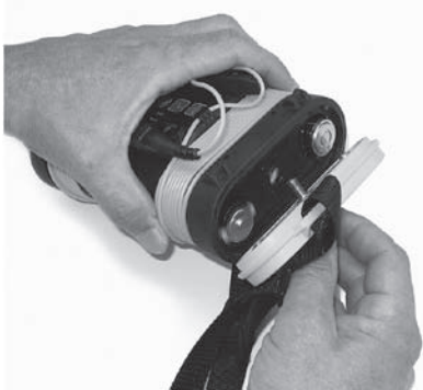
Figura 3: Retirar a tampa do compartimento das pilhas
