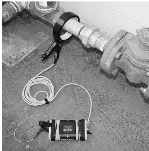
Рис. 9: Индукционный зажим присоединен к проводнику
