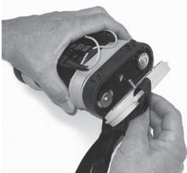
Abbildung 3: Entfernen des Batteriedeckels
