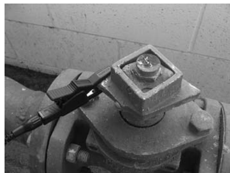
Figure 7: Connexion du ST-305 à une ligne
