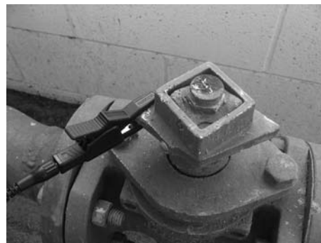
Fig. 7: Tilslutning af ST-305 til en målledeing
