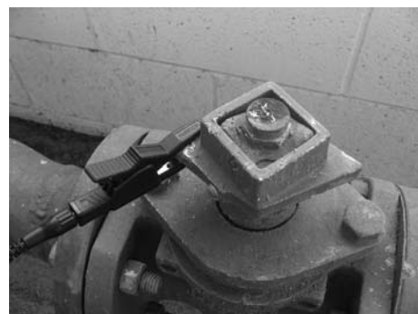
Figura 7: Conexión del ST-305 a una línea
