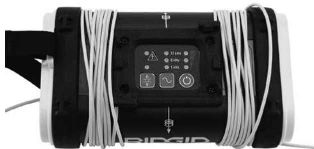
Abbildung 11: ST-305 im Induktionsmodus bei 33 kHz
