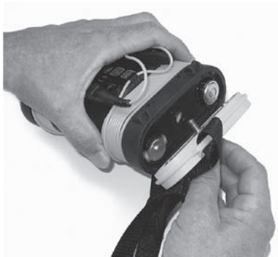
Fig. 3: Aftagning af batteridæksel
