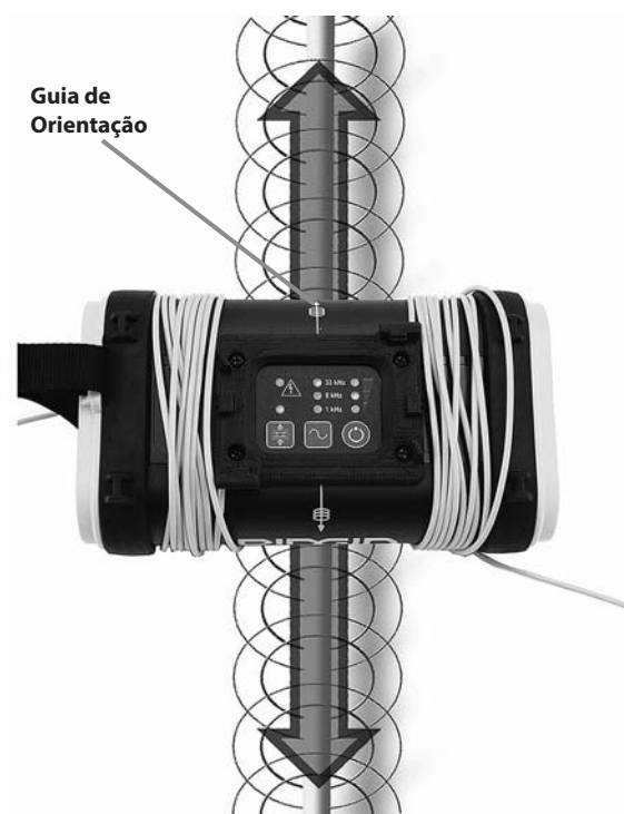
Figura 10: Orientação para a Linha – Modo de Indução
