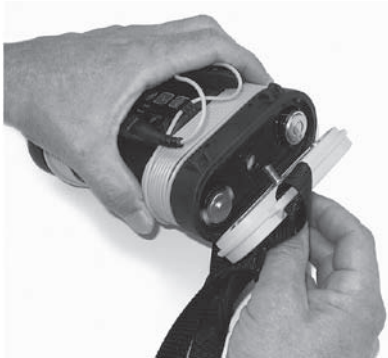
Figuur 3: verwijderen van het batterijdeksel
