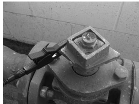
Abbildung 7: Anschließen des ST-305 an eine Leitung
