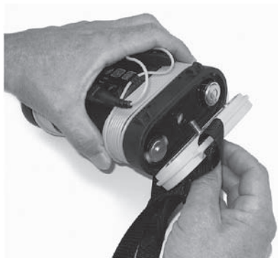
Figure 3: Retrait du couvercle du logement des piles
