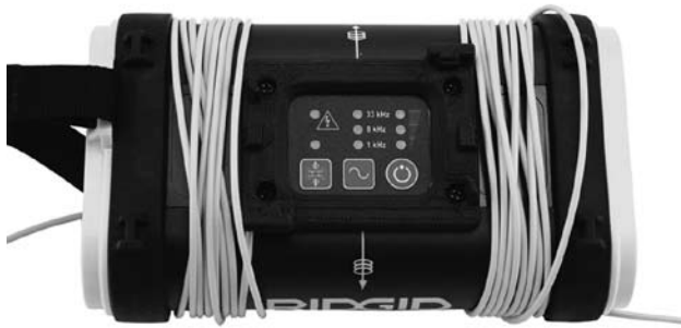
Rysunek 11: Nadajnik ST-305 w trybie indukcyjnym przy częstotliwości 33 kHz
