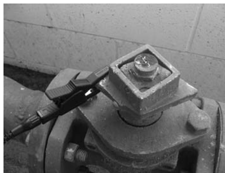
Figura 7: Collegamento dell'ST-305 a una linea
