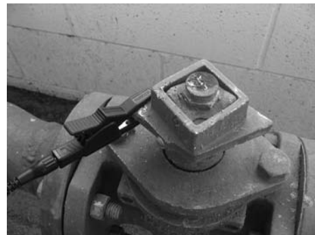
Figuur 7: De ST-305 aansluiten op een leiding
