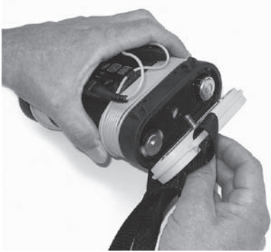
Рис. 3: Снятие крышки с отсека батарей
