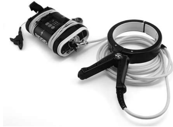
Figura 8: ST-305 con morsetto induttivo
