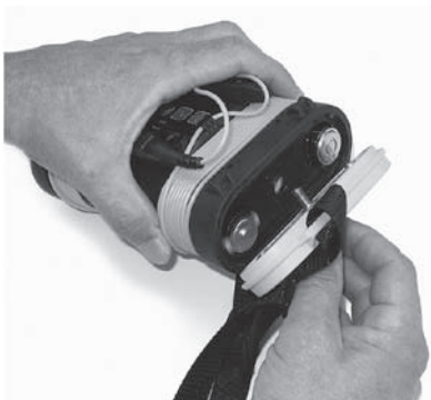
Rysunek 3: Zdejmowanie pokrywy baterii
