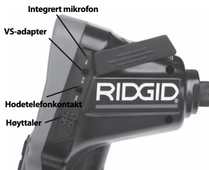
Figur 3 – Portdeksel på høyre side
