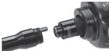
Figura 8 – Ligações de Cabos
